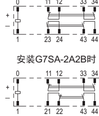
端子配置/内部连接图 (底视图)
